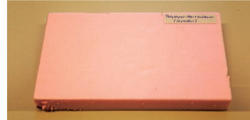
Bei den rosafarbenen Styroporplatten handelt es sich um druckfestes „extrudiertes Polystyrol“, auch als Styrodur bekannt. Es nimmt im Gegensatz zu Styropor keine Feuchtigkeit auf.
